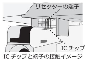
リセッターのスイッチがカートリッジによって押されると、IC チップの書き換えが始まります。赤いランプが 1~2 秒点滅した後、緑のランプが点灯すると正常終了です。失敗すると赤色の点滅が 3 秒以上続きます。その場合は、一旦端子を離し、再度①~②の手順を実行してください。
