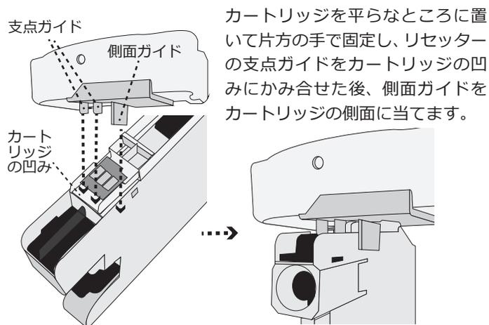
カートリッジを平らなところに置いて片方の手で固定し、リセッターの支点ガイドをカートリッジの凹みにかみ合せた後、側面ガイドをカートリッジの側面に当てます。
