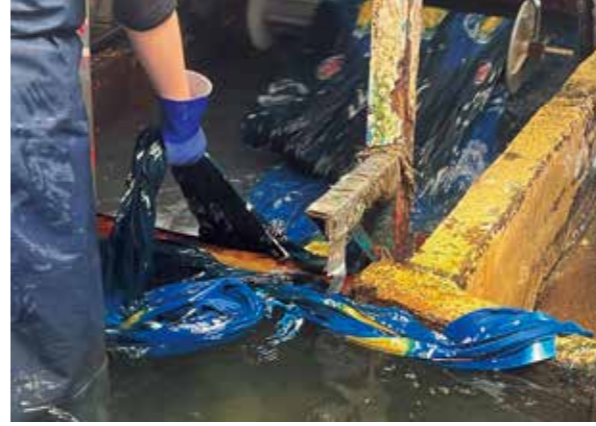
(上) 洗い: 染めがひと通り終わると「川」と呼ばれる洗い場で余分な染料を洗い流す (下) 干し: 十分に水洗いした生地を天日状態の乾燥室で乾燥。昔は天日干ししていた
