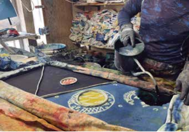
染め：染料が横へ流れてしまわないよう「土手」を作って注ぐ(写真はひっくり返して裏から再度染料を注いでいるところ)。後ろの棚には、色の仕上がりがサンプルとなる「色見本」が積まれている
