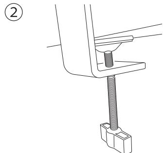
ハンドルを回し、固定ねじを固定場所の幅まで締めて、クランプがしっかりと固定されるようにします。
