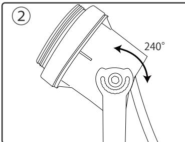
ソケットを任意の角度まで動かし、六角レンチでねじを固定します。
