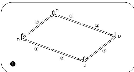
① ①②⑦とAコーナージョイントを図のようにつなげ、ベースフレームを組み立てます。
