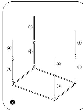
② 組み立てたベースフレームに③④⑤⑥たてパイプ(8本)をさし込みます。
