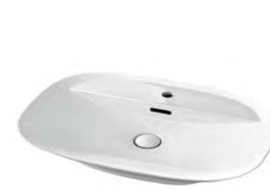
A055 陶器洗面器 ベッセル W700 ・水栓引棒なし ¥59,070 税込 INAX GLOBAL COLLECTION S600 シリーズ W700 × D500 × H126mm 陶器（アクアセラミック） オーバーフローあり 水栓取付穴径：φ 35mm ボウル容量：1.5L 付属品：排水目皿、取付金具（同梱）
