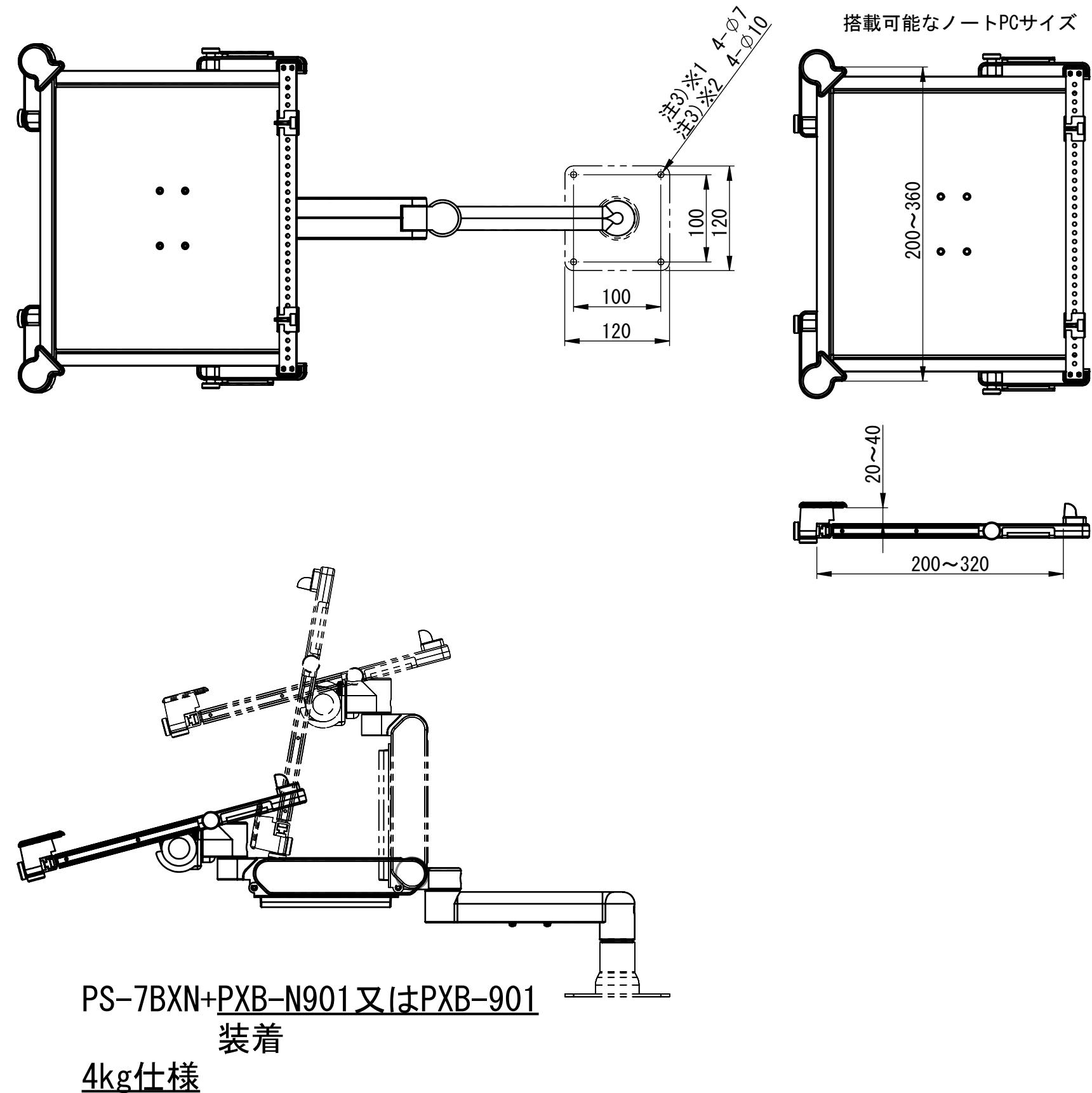
注1)PXA-900 PXA-900W PXA-N901 PXA-901 PS9-N902 装着時の寸法
