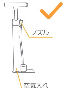
26.後輪に空気を入れる場合は、後輪に付いているキャップを回して外して下さい。英式バルブ対応のノズルの付いた空気入れで空気を入れて下さい。空気を入れた後は必ずキャップを付けて下さい。※空気は入れすぎないように、タイヤを指で押して1cmほど凹むくらいにして下さい。
