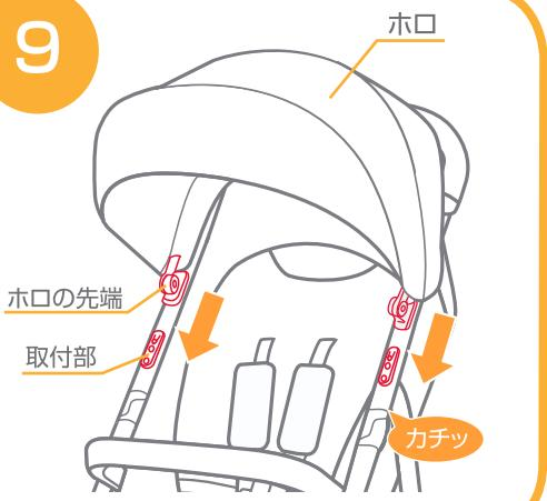
9.ホロの先端を本体の両側に付いている取付部にスライドさせて固定して下さい。
