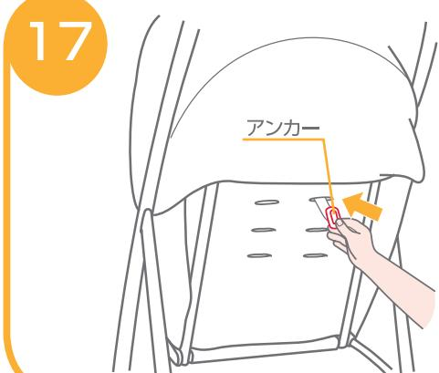
17.肩ベルトの高さを変える場合は、アンカーを図の向きにしながら、背もたれ後部から表側に取り外して下さい。
