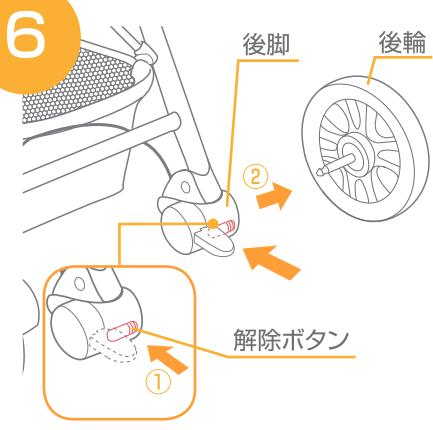
6. 後輪を取り外す場合は、①後脚に付いている解除ボタンを押して、②後輪を取り外して下さい。
