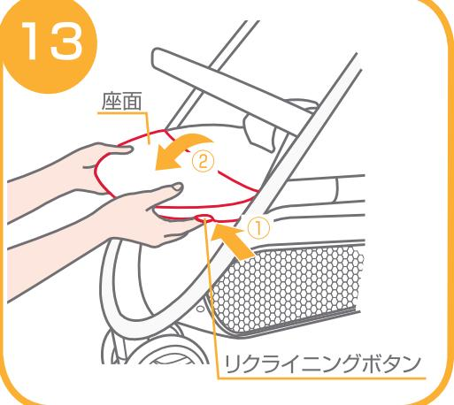
13.座面を下げる場合は、①座面の両側に付いているリクライニングボタンを押して、②座面を下げる下さい。座面を上げる場合は座面を持って上げて下さい。
