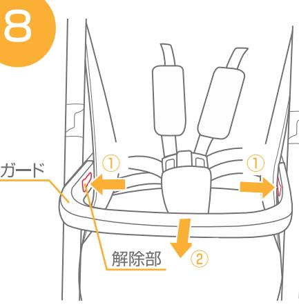
8. ガードを取り外す場合は、①ガードの両側に付いている解除部を押して、②ガードを取り外して下さい。
