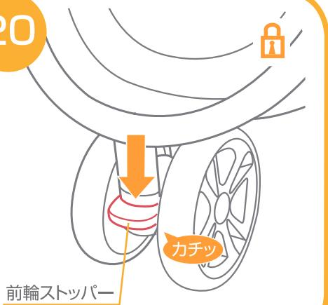
20.前輪ストッパーを下げると、前輪の進行方向が固定されます。前輪ストッパーを上げると前輪が360°キャスター回転します。
