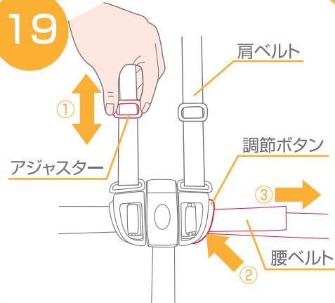
19.①肩ベルトの長さを調節する時はアジャスターで調節して下さい。腰ベルトの長さを調節する時は②調節ボタンを押しながら、③腰ベルトを引っ張り調節して下さい。
