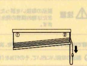
\*幕体取付け後、幕体を上げてみて、左右の高さが合っているかどうか確認してください。
