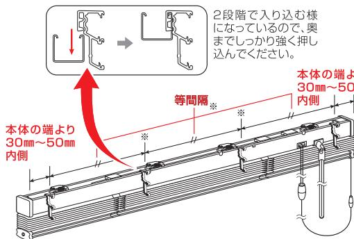
**△注意** バランス用取付パーツ、ブラケットはヘッドボックス内のチルターとコードストッパーの部分を避けて取り付けてください。避けてないで取り付けますとバランス用取付パーツ、ブラケットがチルターとコードストッパーに当たる取り付けができません。必ずご確認ください。
