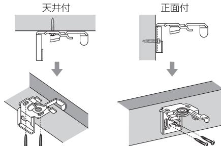
天井付及び正面付のいずれの場合も**木ネジは必ず各2本使用し、しっかりと固定します。**
