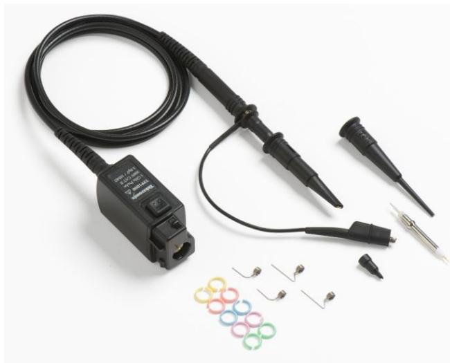
TPP1000 型、TPP0500B 型、TPP0502 型や TPP0250 型は、この製品クラスでは実現できなかった画期的な仕様を持った、広帯域で汎用的に利用できる受動電圧プローブです。テクトロニクス MDO3000 シリーズ、MDO4000 シリーズ、MSO/DPO5000 シリーズ、5 シリーズ MSO オシロスコープ用に設計されており、最高周波数帯域 1GHz、入力容量 3.9pF の性能を持っています。
