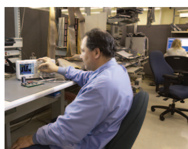
図3. 1000シリーズ ソリューションは、製造やサービスでのテストに必要な合否マスク・テストを標準装備しています。
