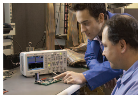
図4. 1000シリーズ オシロスコープの高輝度で鮮明なディスプレイとその広い視野角により、信号の動作をすばやく確認できます。
