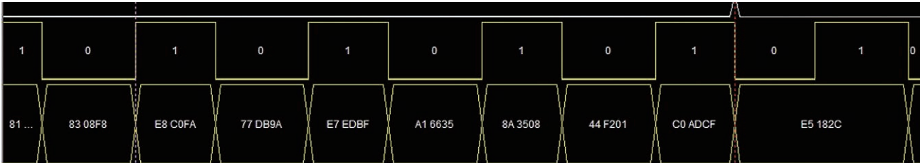
図3. バースト・レコグナイザ・トリガにより、バーストRead/Write時のイベントで簡単にトリガをかけることができます。
