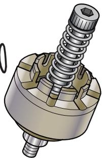
ブリートはダンパーロッド式フロントフォークに組付ける機能強化パーツです。装着によってカートリッジ式のFRフォークのように、伸び側にも減衰機能が付加され、縮み側の減衰力は任意に調整が可能になる、サスペンションの機能を向上させるパーツです。ここではブリートの作動原理を解説します。
