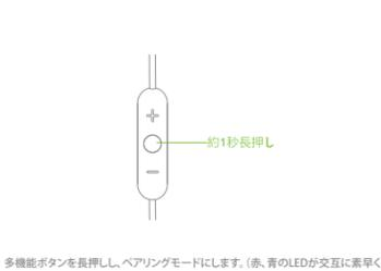
多機能ボタンを長押しし、ペアリングモードにします。(赤、青のLEDが交互に高早く点滅します) 購入後、初めてお使いになる場合は本製品の電源をオンにするだけでペアリングモードになります。通常時は多機能ボタンを赤、青のLEDが高早く交互に点滅するまで長押しします。
