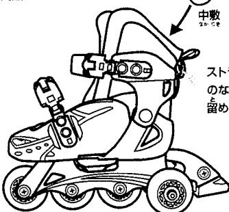
2.バックルは、足がしっかりと固定するようにとめます。必ずロックしてください。カチッと音がすればロックされた状態です。
