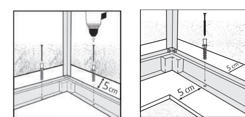
適切なネジとプラグまたはアンカー(付属しておりません)を使用して製品を基礎に固定してください。
