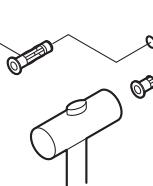
(3) シャワ掛具を止めねじでしっかりと固定します。最後に穴をキャップでふさぎます。
