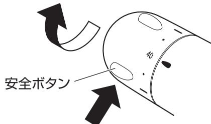
※安全ボタンを押して温度調節ハンドルを回しても高温の湯が出ないときは、給湯機(給湯リモコンなど)の給湯温度を50~60°Cに設定した後、水栓側の温度調節ハンドルをH側へ回してください。
