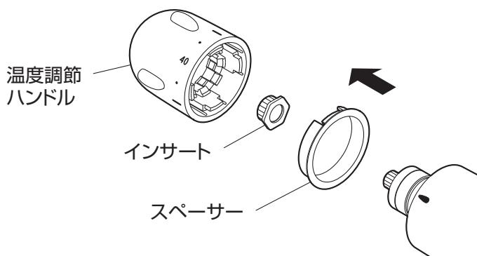
**4 目盛の40の文字と本体のポイント表示を合わせて、温度調節ハンドルを取付けます。**
