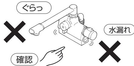
劣化・摩耗などで部品が破損し、やけど・けがをしたり、水漏れして家財などを濡らす財産損害発生のおそれがあります。
