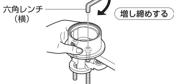
(6) 六角レンチを横にして、左右のボルトを増し締めし、上取付フランジを確実に固定してください。
