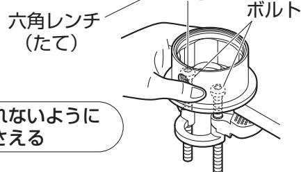
(5) 上取付フランジの位置がずれないように押さえながら、六角レンチをたてにし、左右のボルトを**交互・均等に少しずつ締め**、回らなくなるまで締め付けてください。
