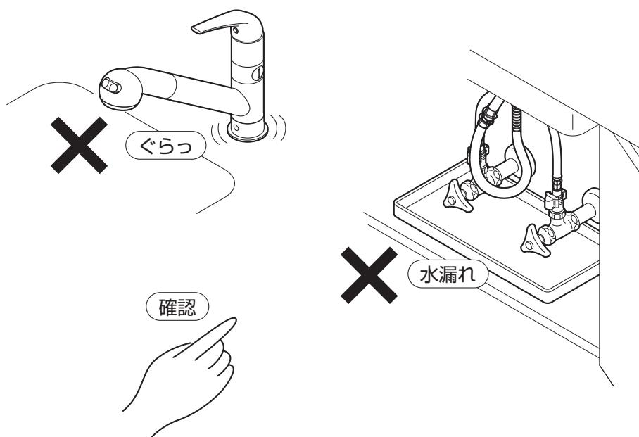
漏水を確認した場合は、止水栓または配管中の元栓を閉めてください。
