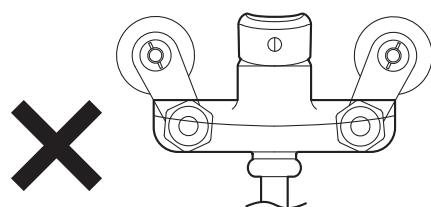
(1) 水栓本体と偏心管の間に、逆止弁コア(寒冷地用はパッキン)が入っている事を確認し、水栓本体がまっすぐになるように偏心管を調節しながら手でナットを締付けていきます。
