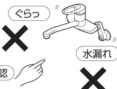
漏水を確認した場合は、流量調節栓または配管中の元栓を閉めてください。
