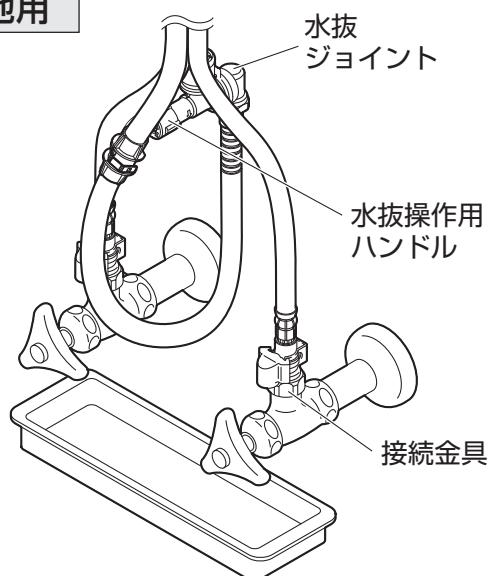
凍結のおそれがある場合に水抜操作用ハンドルを回して水栓内部の水を抜きます。参照：P26
