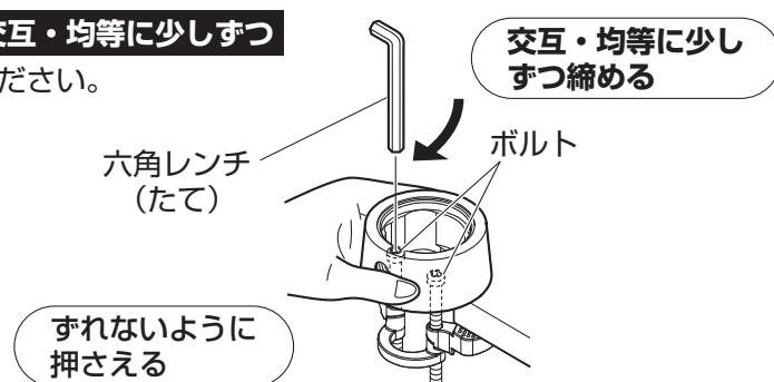
(6) 六角レンチを横にして、左右のボルトを増締めし、上取付フランジを確実に固定してください。
