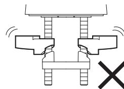
(5) 上取付フランジの位置がずれないように押さえながら、六角レンチをたてにし、左右のボルトを **交互・均等に少しづつ締め**、回らなくなるまで締め付けてください。
