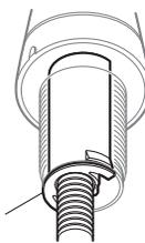
(4) 固定後、(2) ではずしたホース接続金具(寒冷地用は水抜ジョイント)を取付けてください。
