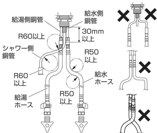
**5 逆止弁（寒冷地用は接続金具）を取付けます。**
