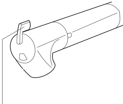
切替レバー シャワー吐水（原水） — ストレート吐水（原水） — ストレート吐水（浄水）
