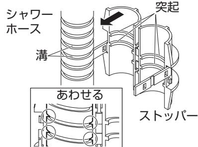
2 はずれ止めの穴にツメを入れます。(右側2箇所、左側2箇所)
