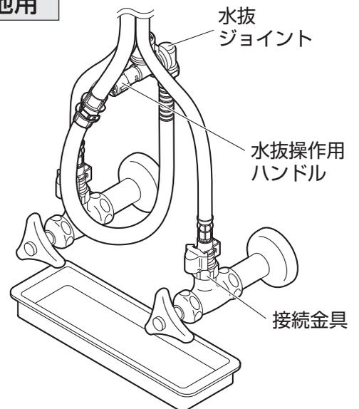
凍結のおそれがある場合に水抜操作ハンドルを回して水栓内部の水を抜きます。参照：P22
