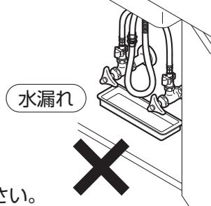
漏水を確認した場合は、止水栓または配管中の元栓を閉めてください。
