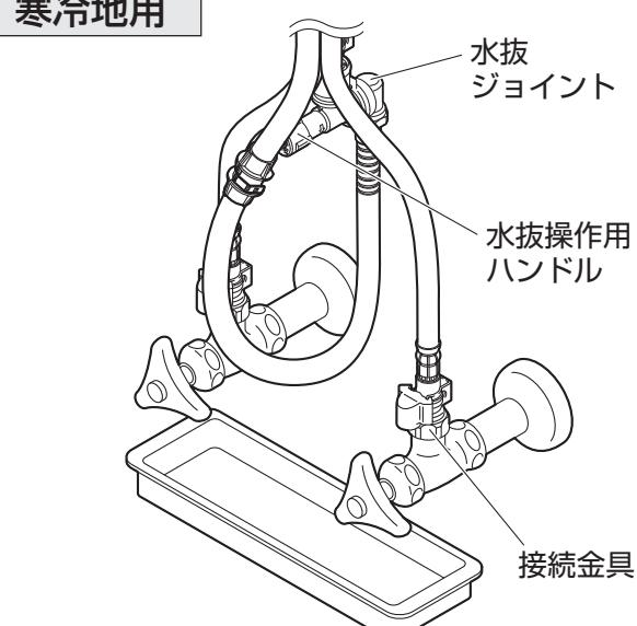
凍結のおそれがある場合に水抜操作用ハンドルをまわして水栓内部の水を抜きます。参照：P20
