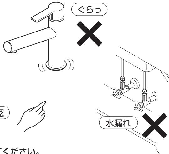
漏水を確認した場合は、止水栓または配管中の元栓を閉めてください。
