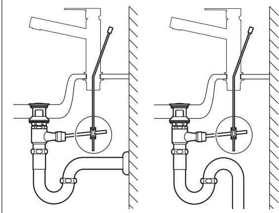
(2) 施工完了後、ポップアップ棒を動かして、取付足などの干渉がない事を確認してください。
