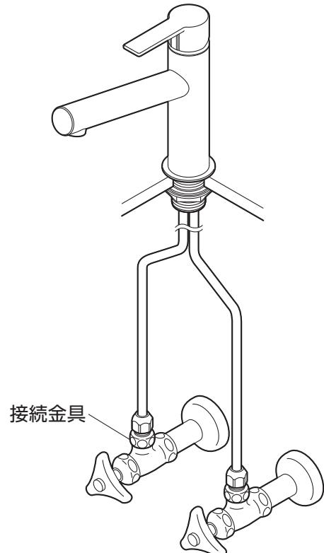
凍結のおそれがある場合にレバーを中央位置で上げて水栓内部の水を抜きます。参考：P15
