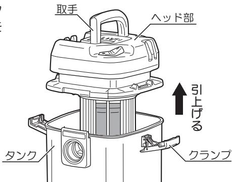
2. ヘッド部のフロートバスケットにカートリッジフィルタをさし込んで取付けます。
