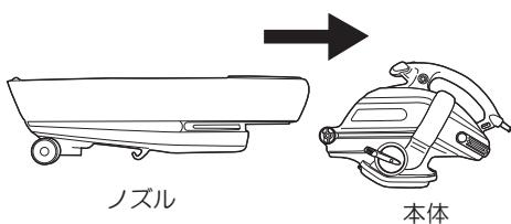
**!** ノズルを本体に装着していないと電源が入らない構造になっています。
