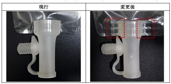
**変更②:**「キャップ挿入部分の凸部」の数が増え、ピッチが短くなります。 これにより、より少ない力でキャップを抜き差しできるようになります。
