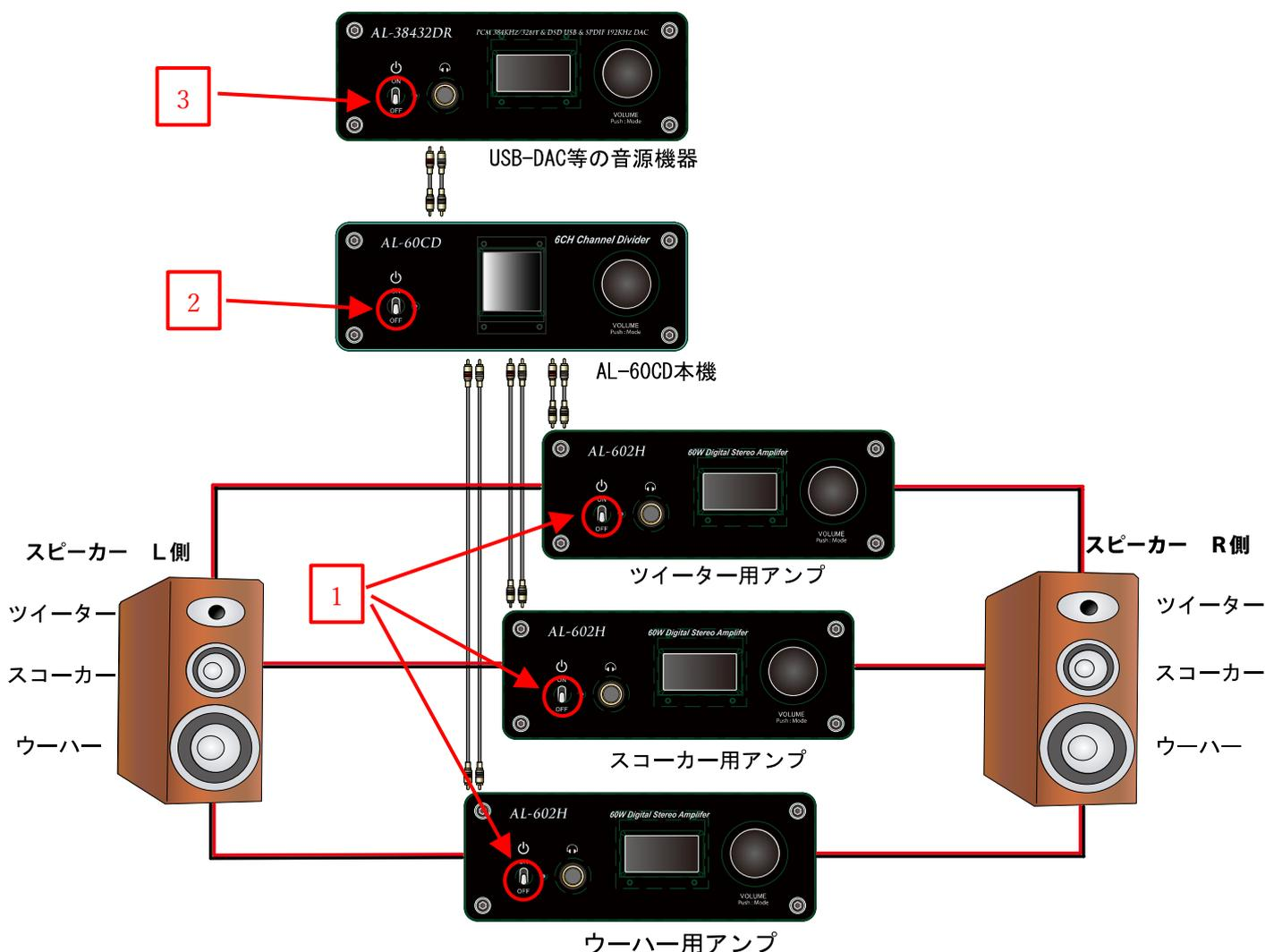
1 各アンプの電源を電源スイッチをオフにして切断します。
