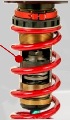
メインパイプ摺動面 マイクロディンプル加工
