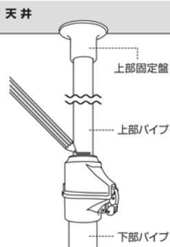
(2) 上部パイプを押し上げて線を15~25mm程度上げてください。押し上げがゆるいと転倒の危険がありますので、しっかりと押し上げてください。
