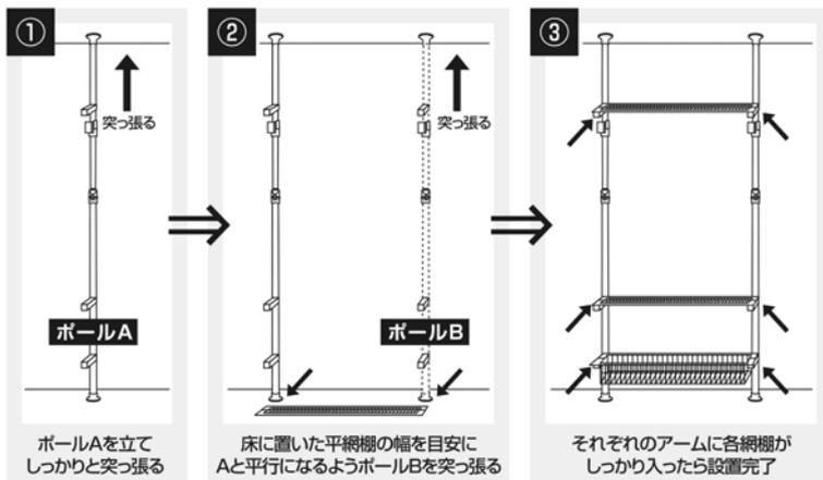
ご注意: 平網棚、深網棚はアームにある3カ所の溝にしっかりと差し込んでください。設置後はアーム背面にある固定ボルトをしっかりと締めてください。固定ボルトを締めないと十分な耐荷重を得ることが出来ません。
