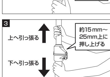
3. 天井に接したら、スイッチから手を放します。上部は上方に向、下部は下方に向、力を入れて引つ張ります。
