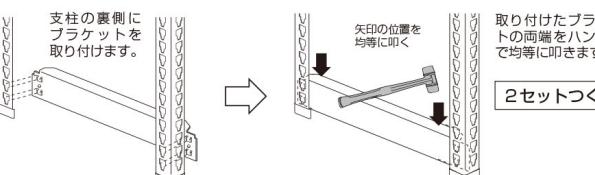
③②で組み立てた2セットの間に後面にブラケット（長）を取り付けます。
