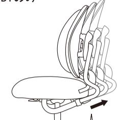
必ず両側のフレームをもって調整してください。片方のフレームだけ引っ張らないでください。ツマミはしっかりと締めてください。
