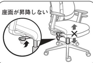
レバーを上げても座が昇降しない場合は、ガスシリンダー上部が差し込まれていない可能性があります。右図のように、座面の上から、体を落として、体重をかけるような動作を数回繰り返して、上からの強い衝撃を加えてガスシリンダーをはめ込みます。
