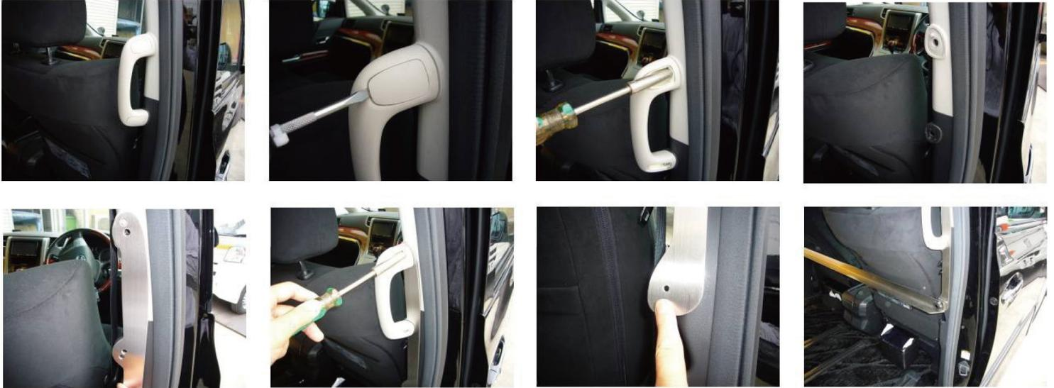
前側フレームはアシストグリップを利用して固定します。ドライバー等でアシストグリップのカバーを外し10mm頭ボルトを外し、アシストグリップを外して下さい。
