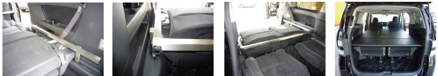
サードシートのレールに写真のようにフレームを差し込んで下さい。この際、ゴムカバーをめくって差し込んで下さい。
