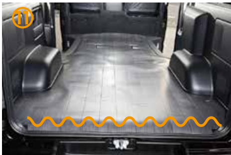
⑪フローアエンドのスキットプレート部分はスキットプレートの上に敷いて下さい。
