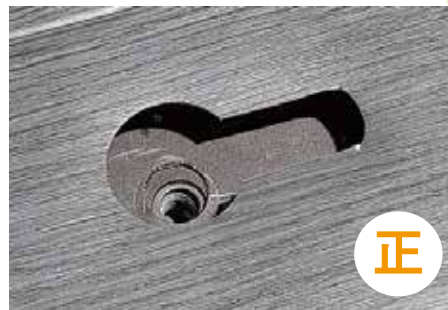
⑧じゅうたんが穴を塞がないように注意して下さい。目安として純正穴と同じ位置にくるようにシート取付け穴に合わせて位置出しが簡単に出来ます。
