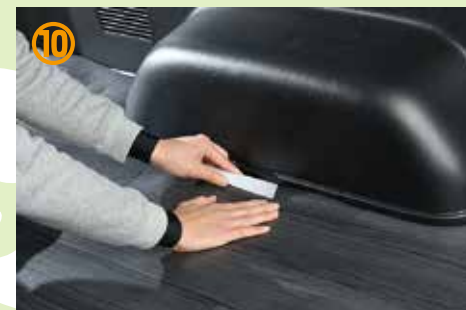
⑩サイドトリム、ステップトリムのすき間に差し込みにくい時はへらなどで作業するとスムーズに出来ます。
