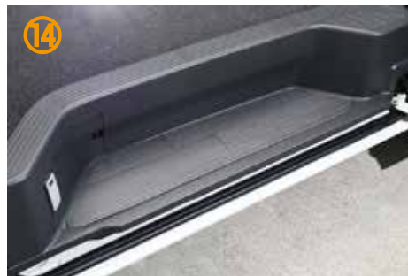
⑭パワースライドドア付き車のステップ部のマットはこの状態です。 (使用状況に応じて裏面を両面テープで止めて下さい。)
