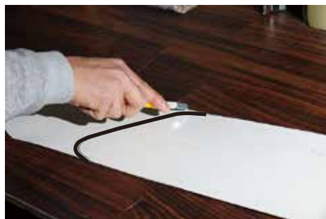
⑬ステップ部のマットはパワースライド無しの型でカットしてありますので、 パワースライドドア付き車は裏面の罫書きに沿ってカットして下さい。
