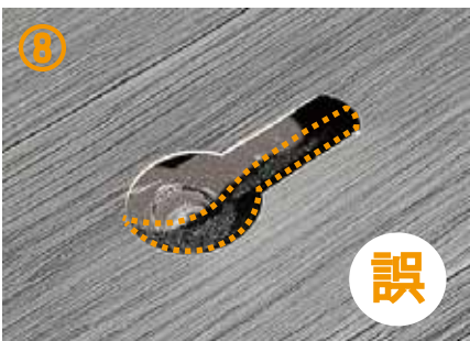
⑧じゅうたんが穴を塞がないように注意して下さい。目安として純正穴と同じ位置にくるようにシート取付け穴に合わせて位置出しが簡単に出来ます。
