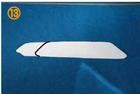
⑬ステップ部のマットはパワースライド無しの型でカットしてありますので、 パワースライドドア付き車は裏面の罫書きに沿ってカットして下さい。
