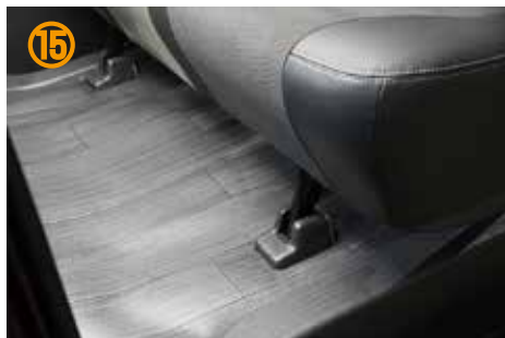
⑮セカンドシートを元の状態に戻し、 ボルトを14mmBOXレンチでしっかり締めて下さい。
