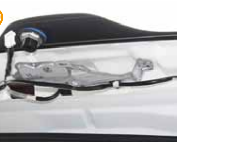
㉘～㉚トリムカバーの浮きが気になる場合はモーターをばらし、ブラケットのみ取付けてから、トリムカバーを戻して下さい。
