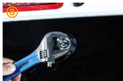
⑥～⑨純正カバーを外し、モンキーレンチでワイパーモーターのナットを外して下さい。
