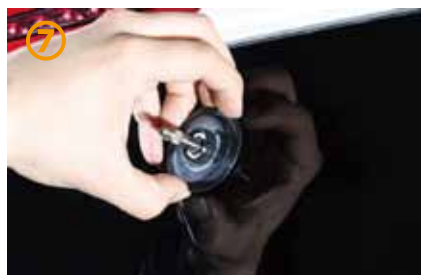
⑥～⑨純正カバーを外し、モンキーレンチでワイパーモーターのナットを外して下さい。
