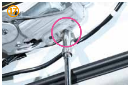
⑩～⑱赤○部分のボルトを3カ所、外して下さい。その際、モーターの落下に注意して下さい。
