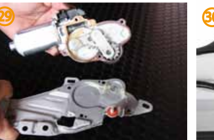
㉘～㉚トリムカバーの浮きが気になる場合はモーターをばらし、ブラケットのみ取付けてから、トリムカバーを戻して下さい。
