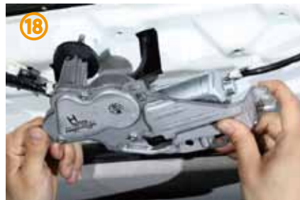
⑩～⑱赤○部分のボルトを3カ所、外して下さい。その際、モーターの落下に注意して下さい。
