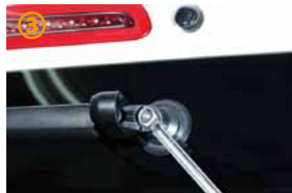
②～③キャップを浮かし、10mm ナットを緩めて下さい。ナットは完全に外さないで下さい。
