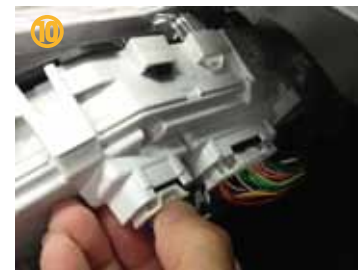
⑩ 画像のようにカプラーのレバーにツメをかけてカプラーを外して下さい。
