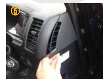
⑤ 運転席側のサイドパネルを取り外して下さい。
