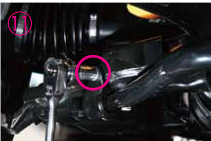
⑪~⑭純正のスタビライザーを固定しているネジを緩めて下さい。
