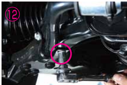
⑪~⑭純正のスタビライザーを固定しているネジを緩めて下さい。
