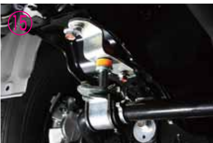
⑪~⑭純正のスタビライザーを固定しているネジを緩めて下さい。
