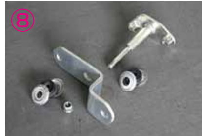
⑦~⑩Z型ステーから純正品を外し、本商品と交換して下さい。ブッシュの締め付けはネジが1~2山出る程度にして下さい。
