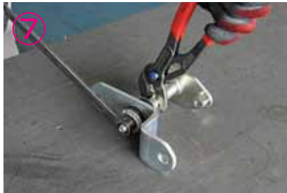
⑦~⑩Z型ステーから純正品を外し、本商品と交換して下さい。ブッシュの締め付けはネジが1~2山出る程度にして下さい。
