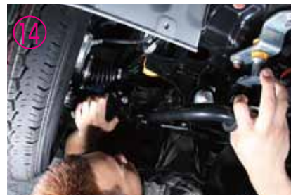
⑦~⑩Z型ステーから純正品を外し、本商品と交換して下さい。ブッシュの締め付けはネジが1~2山出る程度にして下さい。
