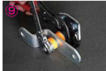
⑦~⑩Z型ステーから純正品を外し、本商品と交換して下さい。ブッシュの締め付けはネジが1~2山出る程度にして下さい。
