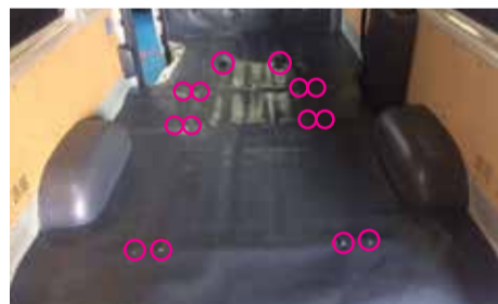
純正の荷掛けフックで固定して下さい。ボルトは付属のM8x60mmを使用。M8ボルト・スプリングワッシャー・平ワッシャーの順で使用して下さい。
