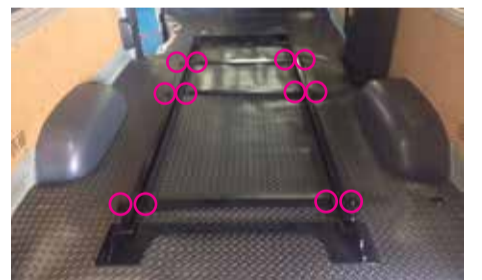
角パイプより出ているボルト部分のマットをカットし、フレームを付属のナットで固定して下さい。
