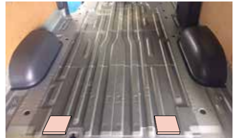
木製シムを両面テープ等で固定して下さい。(左図参照)
