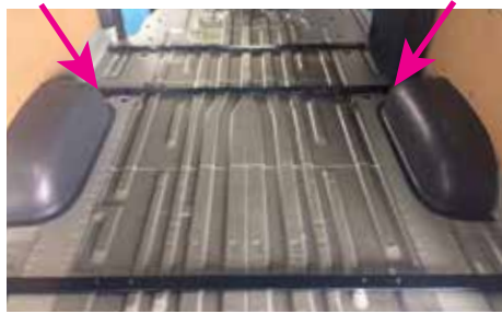
矢印の位置に穴あけ加工を行います。左右1ヶ所ずつ計2ヶ所。
