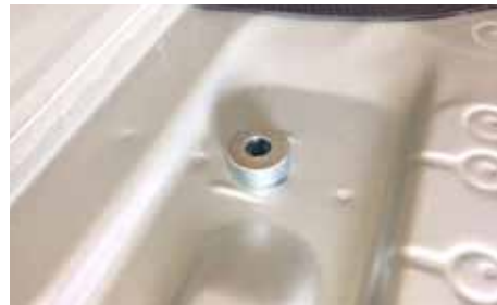
シルバーのシム(メッキ)を、穴あけした場所と、タイダウンフックの位置に置いて下さい。
