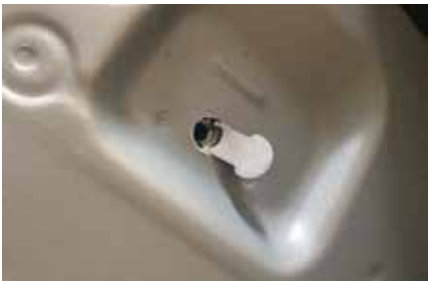
付属のインプラナットを入れ、インプラナットのステーをテープなどで固定して下さい。
