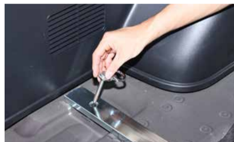
純正の荷掛けフックで固定して下さい。ボルトは付属のM8x60mmを使用。M8ボルト・スプリングワッシャー・平ワッシャーの順で使用して下さい。
