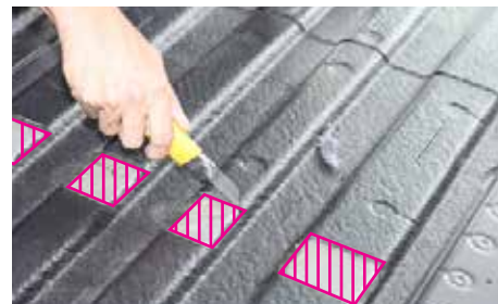
接面のタールを剥がして下さい。
