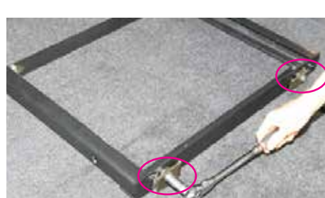
マットを戻し、フレームにあたる部分のみマット裏フェルトをカットし、取り外して下さい。
