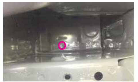
下から覗き、印の位置を目掛けて、長いドライバーなどで突いて下さい。
