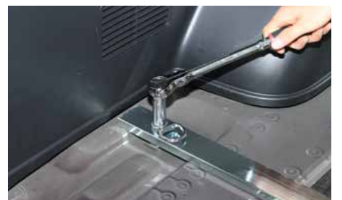
純正の荷掛けフックで固定して下さい。ボルトは付属のM8x60mmを使用。M8ボルト・スプリングワッシャー・平ワッシャーの順で使用して下さい。
