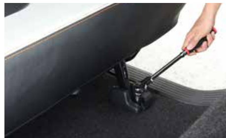
車内よりセカンドシートを外して下さい。
