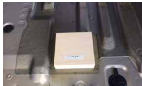
木製シムを固定する場所のタールは剥がして下さい。
