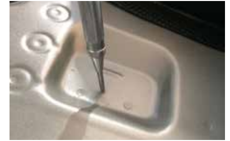
室内側からポンチで突いて下さい。
