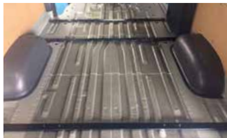
パイプフレームを仮置きして下さい。
