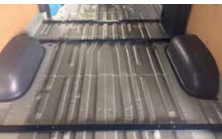
木製シムを固定する場所のタールは剥がして下さい。
