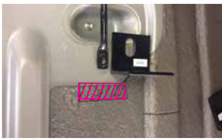
L型固定ブラケットを固定して下さい。
