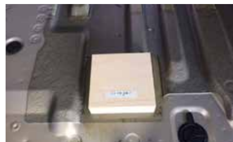
室内側からポンチで突いて下さい。
