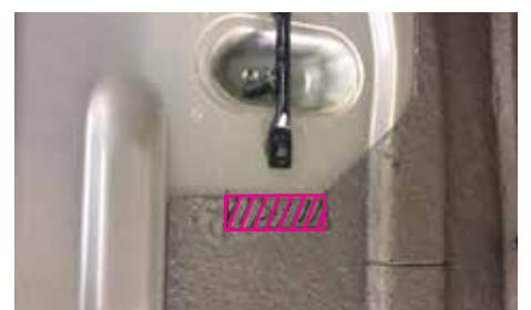
L型固定ブラケットを止める前に一度仮合わせをし、干渉する部分のタールを剥がして下さい。
