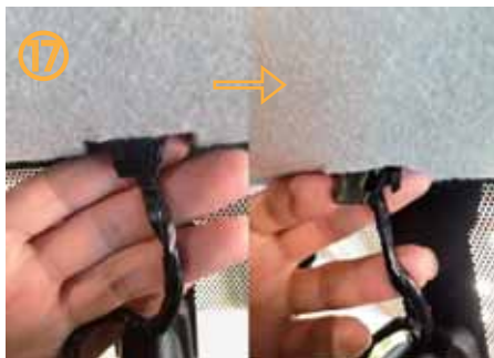
⑰ ラインガイドを外して下さい。配線をラインガイドから外して天井の中引きこみます。 天井が元に戻らない可能性がありますので必ず行って下さい。
