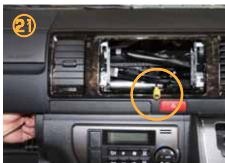
㉑ グローブBOX 上部を通しデッキ裏まで配線して頂き、ナビのカメラ入力と接続して下さい。
