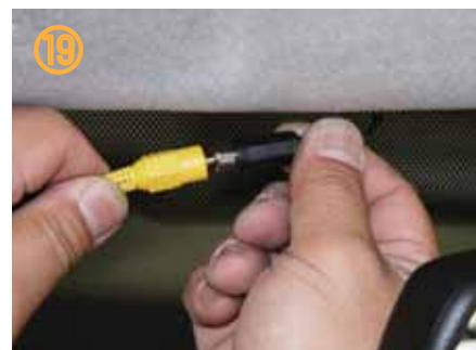
⑲ 商品とモニター配線 (RCA ケーブル) を接続して下さい。
