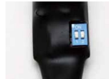
②5 本体ディップスイッチを好みのモードに設定し、動作確認をして下さい。動作に問題がなければ、車両を元の状態に戻して下さい。
