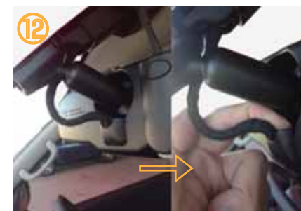
⑫ ルームミラー裏側のコネクターを取り外して下さい。
