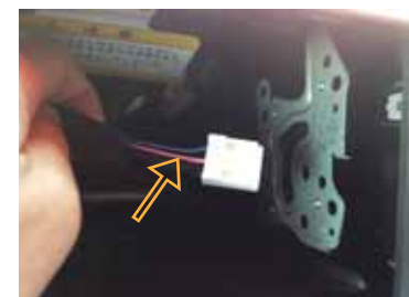
②3 RCAケーブルとナビ本体のカメラ入力線を接続します。続いてピンク色の配線を5ピンカプラーのピンク配線(車速パルス)と接続し、絶縁テープで保護して下さい。
