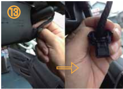
⑬ ミラー裏カバーをミラーのカバー (黒色) ごと取り外して下さい。
