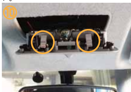
⑩ ○の位置にピンがありますので押さえながら外して下さい。無理に外すとピンが折れやすいので注意して下さい。
