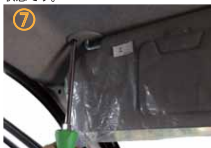
⑦ プラスドライバー #3 を使用してサンバイザーを取り外して下さい。
