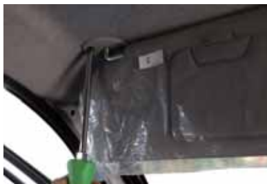
プラスドライバー #3 を使用してサンバイザーを取り外して下さい。
