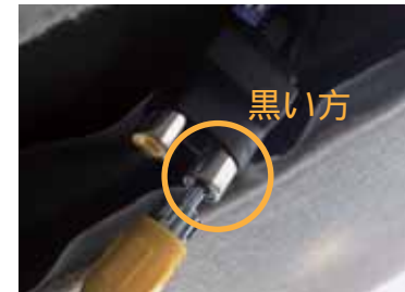
商品とモニター配線(RCAケーブル)を接続して下さい。Aピラーをつたい配線して下さい。 黄色側は追加カメラ用です。
