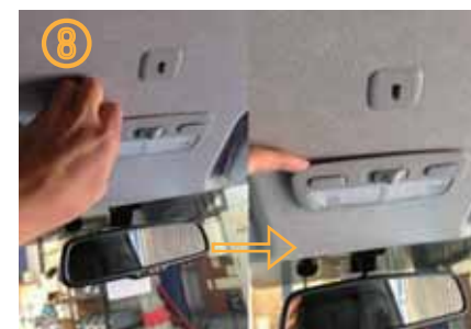
⑧ マップランプのカバーに爪を入れて少し浮かせて下さい。
