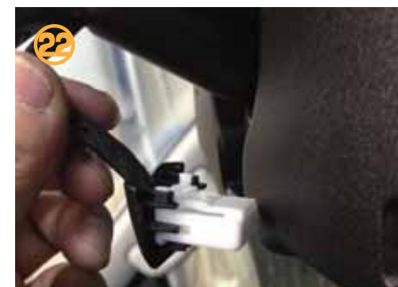
㉒ 商品カプラー (オス側) に で取り外したミラー裏カバーを取り付けし、ミラーに接続して下さい。
