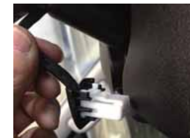
②4 商品カプラー(オス側)に で取り外したミラー裏カバーを取り付けてミラーに接続して下さい。
