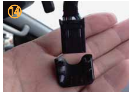
⑭ ミラー裏カバーのカバーを取り外して下さい。
