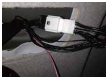
ミラー後の取り外した純正カプラー(オス側)をマップランプの裏へ引き込み、商品本体のカプラーを接続して下さい。
