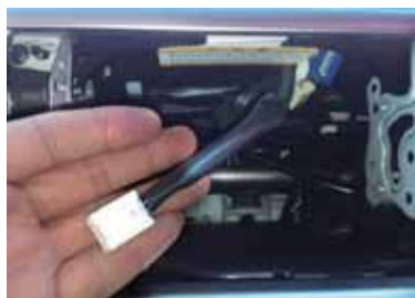
②1 ナビ裏の4本の配線がつながった5ピンカプラーを見つけて下さい。
