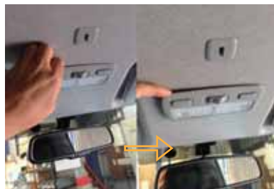
マップランプのカバーに爪を入れて少し浮かせて下さい。
