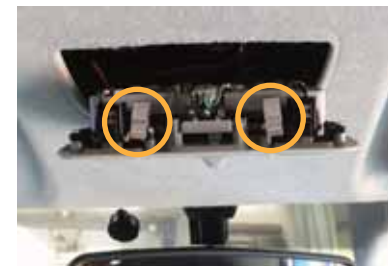
○の位置にピンがありますので押さえながら外して下さい。無理やり外すとピンが折れやすいので注意して下さい。
