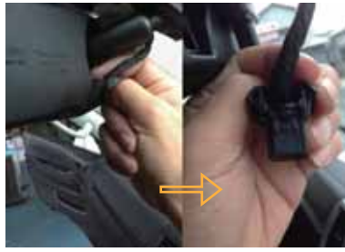
ミラー裏カプラーをミラーのカバー（黒色）ごと取り外して下さい。
