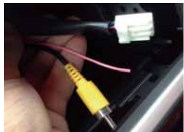
②2 で入線したピンク色配線とRCAケーブルを手順 で外したピラーを通してナビ裏まで配線して下さい。
