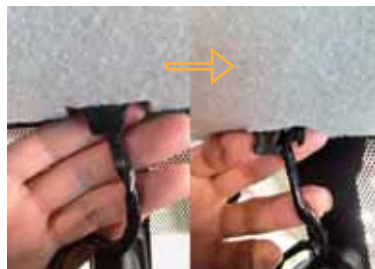
ラインガイドを外して下さい。配線をラインガイドから外して天井の中に引きこみます。 天井が元に戻らない可能性がありますので必ず行って下さい。
