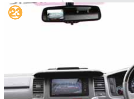
㉓ ギアをバックに入れて、ナビ側に映像が映るかをチェックして下さい。その後、ナビを取り付けて、インストルメントパネルを戻せば完成です。
