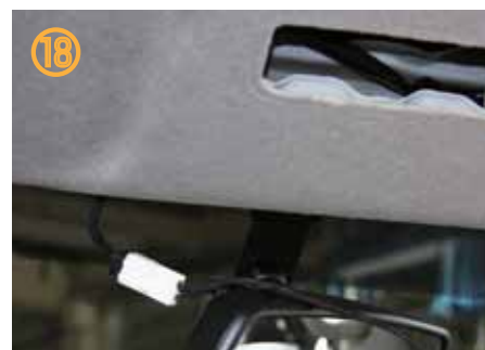
⑱ ミラー裏の取り外した純正カプラー (オス側) をフロントガラス側から出し商品本体カプラーと接続して下さい。
