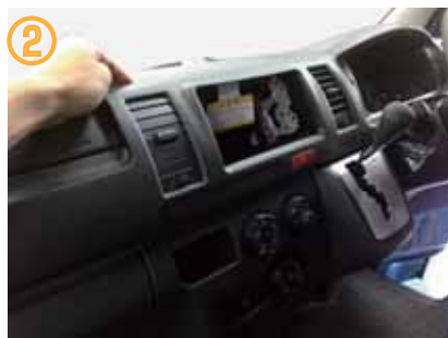
② インストルメントパネル(メイン部)を取り外して下さい。
