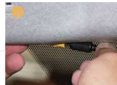
⑳ 接続した後天井トリムの中に戻し、手順 ~ で外した A ピラーに沿って配線して下さい。
