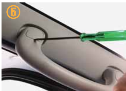
⑤ 小さなドライバーでボルトカバーを取り外して下さい。傷つきやすいので注意して下さい。
