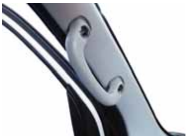
プラスドライバー #3 を使用してアシストグリップを取り外して下さい。
