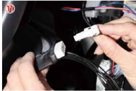
⑪ 3本を差し込んだ純正カプラーを、本ユニットに差し込みます。
