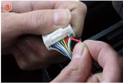
⑨、⑩ カプラー拡大図を参考に赤・青・灰の3本をカプラーに差し込んで下さい。
