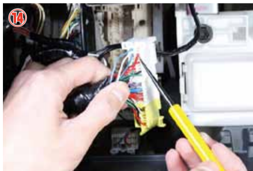
⑬～⑭ ジャンクションボックス側の赤・青・灰の3本を、ジャンクションボックス拡大図を参考に配線して下さい。
