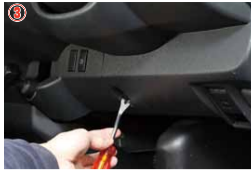
②～④ 左側にあるジャンクションボックスを外し、浮かせて下さい。
