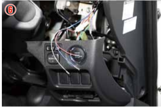
⑥ 付属の赤・青・灰のコード3本をナビ裏に通し、運転席側のドアミラースイッチ裏まで配線して下さい。 注意：ギボシ側をミラースイッチの方に配線して下さい。
