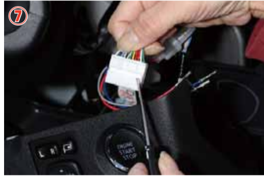
⑦、⑧ ドアミラースイッチ裏のカプラーを外し、端子ロックを小さなマイナスドライバーなどで展開して下さい。
