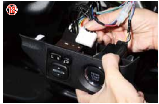
⑫ 本ユニットより出ているカプラーをミラースイッチに差し込んで下さい。
