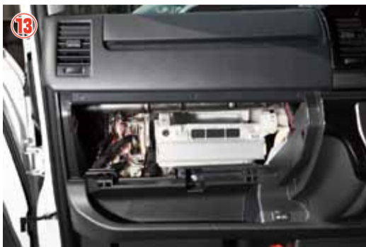
⑬～⑭ ジャンクションボックス側の赤・青・灰の3本を、ジャンクションボックス拡大図を参考に配線して下さい。
