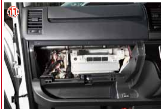
⑪～⑭ 4型前期車用(2013年12月～2017年12月)の場合 ジャンクションボックス側の赤・青・灰の3本を、裏面のジャンクションボックス拡大図を参考に配線して下さい。
