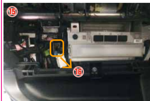
⑮、⑯ 4型後期車用(2017年12月～)の場合 ジャンクションボックス側の青・灰の2本を、裏面のジャンクションボックス拡大図を参考に配線して下さい。 ジャンクションボックス側の赤の配線を、 □ に配線して下さい。
