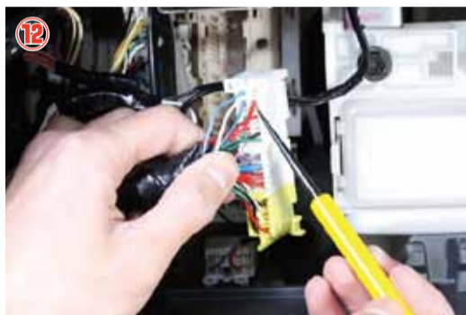
⑪～⑭ 4型前期車用(2013年12月～2017年12月)の場合 ジャンクションボックス側の赤・青・灰の3本を、裏面のジャンクションボックス拡大図を参考に配線して下さい。
