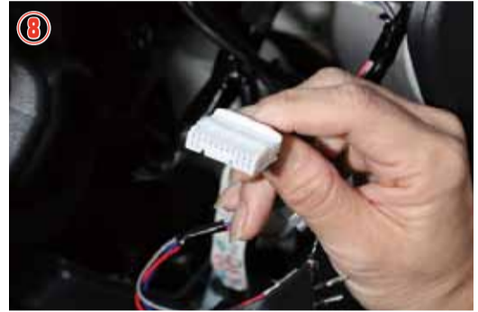
⑦、⑧ ドアミラースイッチ裏のカプラーを外し、端子ロックを小さなマイナスドライバーなどで展開して下さい。
