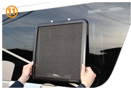
11. 下側のステーとのネジ穴が 合う位置に仮止めて 下さい。
