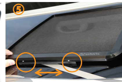
5. 手順4で調整した本体に対し、 下側のステーのネジ穴が合う ようにステー位置を調整して 下さい。
