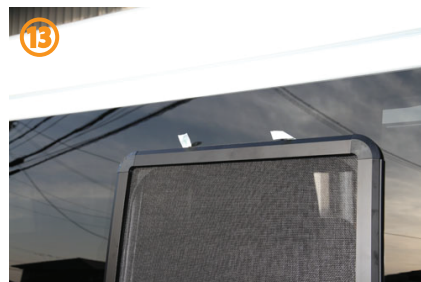
13. 上側ステーの両面テープを 剥がし、本体を固定します。
