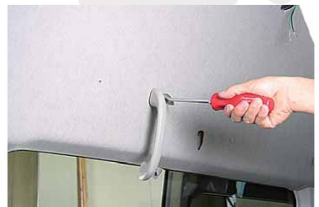
～ 天張りを元に戻しクリップで各箇所を固定した後、先ほどの 印から計測した場所にブラケット側の穴があるのを確かめて下さい。ブラケット側の穴が確認出来れば付属の6mmボルトでアシストグリップを固定して下さい。
