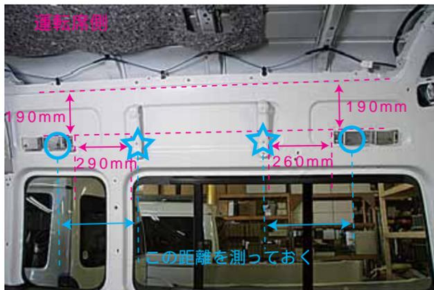
反対側も同様にステンレス固定ブラケットを取付して下さい。
