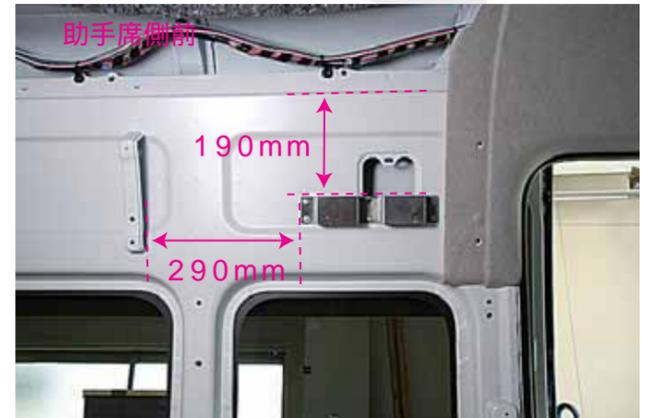
～ 天張りを外した後、後側と前側にステンレス固定ブラケットを取付して下さい。ドリル下穴:9mm ターンナット:M5 を使用。
