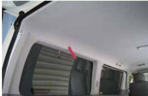
内張おこしを使用し、後部側の天張りのクリップを全て外し、車内より天張りパネルを降ろして下さい。
