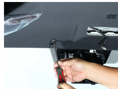
⑨～⑩プラスドライバー#3を使用してサンバイザーを取り外して下さい。
