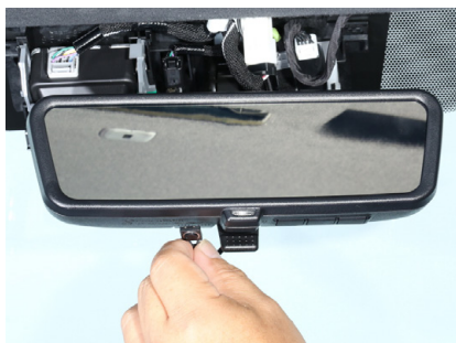
⑯ルームミラーの下側等の押しやすい場所にフロント/サイド切替スイッチを両面テープ等で取付けてください。
