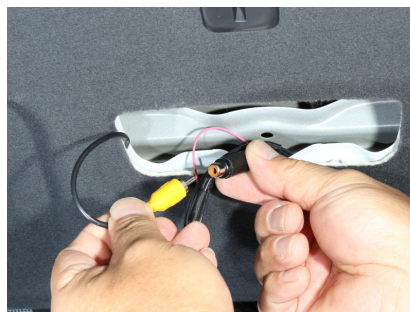
⑭バックカメラ用 RCA ケーブルを接続してください。
