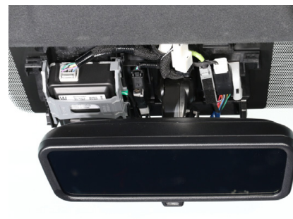
⑰カメラカバーが元通り取付けられるように配線類をキレイに配置してください。カバーを戻せばルームミラー周りは完成です。
