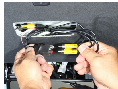
⑮サイドカメラからの RCA ケーブルを赤色、フロントサイドカメラからの RCA ケーブルを白色に接続してください。
