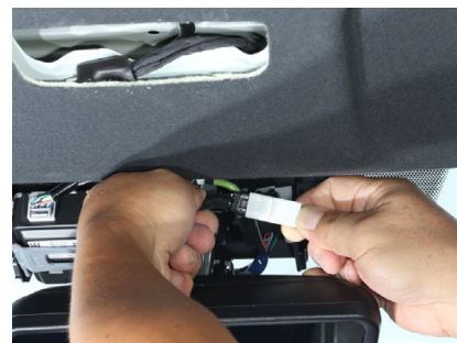
⑫手順⑥で外した黒色カプラー(オス)と本商品の白色カプラー(メス)を取付けてください。
