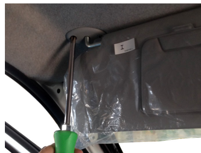
⑨～⑩プラスドライバー#3を使用してサンバイザーを取り外して下さい。
