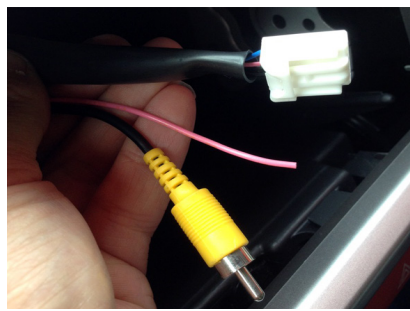
⑱～⑲ハーネス本体から出ているピンク色(車速)配線をナビ裏にある4本配線の5ピンカプラー横まで配線してください。 バックカメラ用 RCA ケーブルも A ピラーを通しナビ裏まで配線して下さい。
