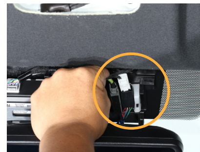
⑬本商品の白色カプラー(オス)を手順⑥で外した本体に取付けてください。
