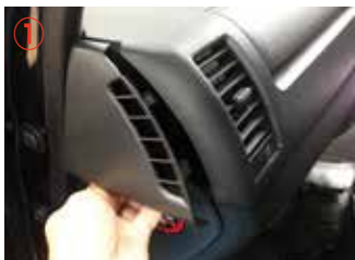
① 助手席側サイドパネルを外して下さい。
