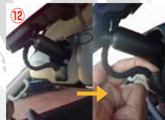
⑫ ルームミラー裏側のコネクターを取り外して下さい。
