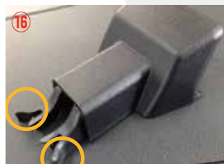
⑯ ○の箇所を押して外します。
