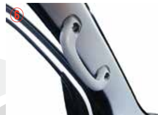
⑥ プラスドライバー#3を使用してアシストグリップを取り外して下さい。
