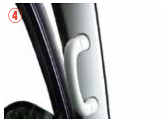
④ 左側 A ピラーを取り外していきます。
