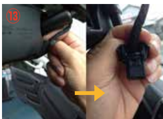
⑬ ミラー裏カプラーをミラーのカバー (黒色) ごと取り外して下さい。
