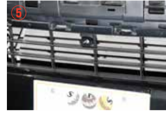
カメラブラケットを、純正ボルト(2)で外した)を使い固定して下さい。
