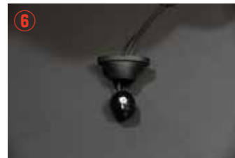
カメラ配線をカメラ固定ラバーに通して下さい。
