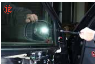
左ドアトリムを外し、左ドアミラーを外して下さい。
