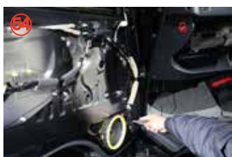
カメラ配線は純正ハーネスと同じように通し、スピーカー横のグローメットより入れて下さい。
