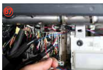
※電源は ACC より接続して下さい。 4型前期 (~2017.12) までは、オーディオ裏又は、ジャンクションブロック (図 1) を参考にして下さい。 4型後期 (2017.12 ~) は、シガーライター裏などに接続して下さい。
