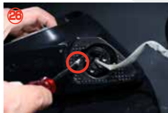
モーター下のプラスタッピング1本を外し、モーターとミラーカバーを外して下さい。
