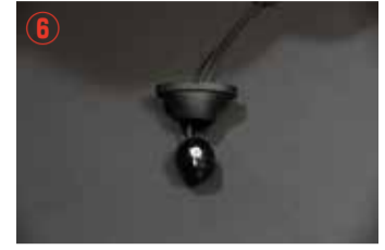
カメラ配線をカメラ固定ラバーに通して下さい。
