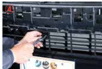
カメラブラケットを、純正ボルト(②で外した)を使い固定して下さい。
