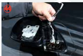
※ ご注意下さい ※ 配線が噛まないように気を付けて下さい。
