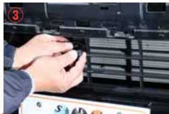
カメラブラケットを、純正ボルト(②で外した)を使い固定して下さい。
