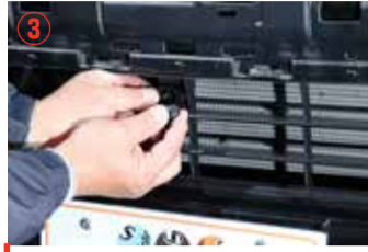
カメラブラケットを、純正ボルト(2)で外した)を使い固定して下さい。
