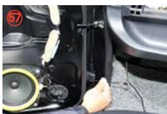
ドア内部を通り、ドア前方のグローメットから出して下さい。
