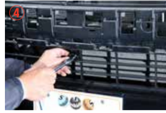
カメラブラケットを、純正ボルト(2)で外した)を使い固定して下さい。
