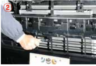
フロントバンパースリット中央部分のバンパーを固定しているボルトを外して下さい。
