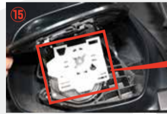
マイナスドライバーなどでミラーカバーとミラーを外して下さい。 ⑬の矢印部2カ所を外せば、ミラーカバーとミラーが外れます。
