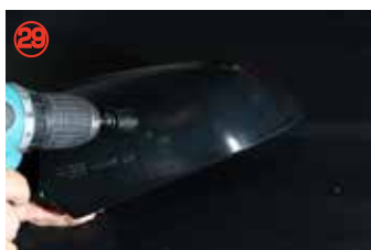
19mmのホルソなどで、19mmの穴を開けて下さい。
