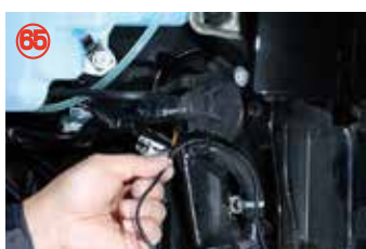
フロントカメラの配線を通した位置より室内に通して下さい。
