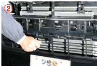
フロントバンパグリル中央部分のバンパーを固定しているボルトを外して下さい。
