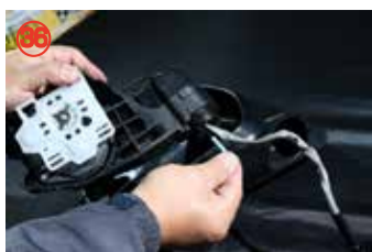
カメラ配線は純正配線と同じように通して下さい。
