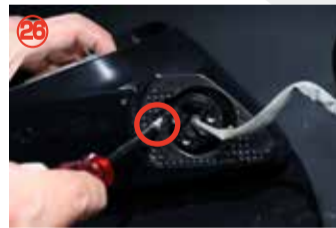
モーター下のプラスチック1本を外し、モーターとミラーカバーを外して下さい。
