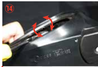
マイナスドライバーなどでミラーカバーとミラーを外して下さい。 ⑬の矢印部2カ所を外せば、ミラーカバーとミラーが外れます。
