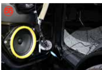
ドア内部を通り、ドア前方のグローメットから出して下さい。
