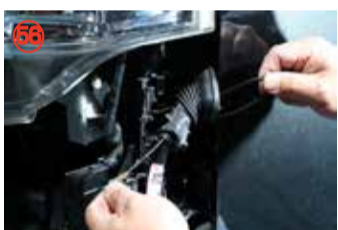
ドア内部を通り、ドア前方のグローメットから出して下さい。
