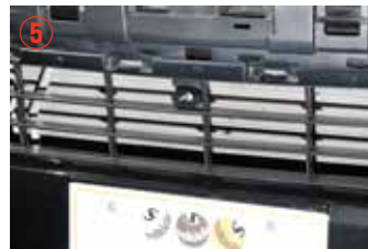
カメラブラケットを、純正ボルト(②で外した)を使い固定して下さい。
