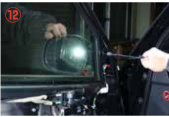
左ドアトリムを外し、左ドアミラーを外して下さい。
