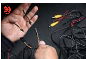
フロント・サイドカメラケーブルを各延長ケーブルに接続して下さい。
