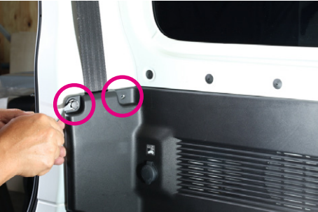
サイドトリムのクリップピン2箇所を外してください。
