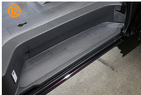
⑫ パワースライドドア無し車のステップ部のマットはこの状態です。 (使用状況に応じて裏面を両面テープで止めて下さい。)
