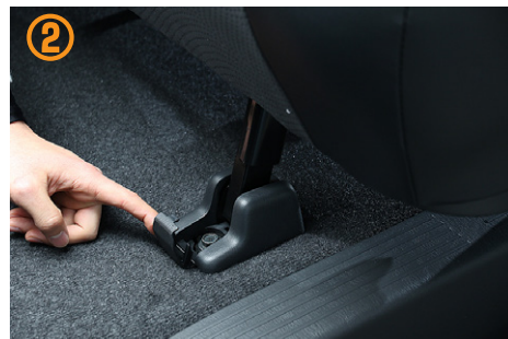
②シートを取り外していきいます。セカンドシート前足のボルトカバーを開いて下さい。
