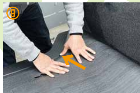
⑨ステップトリムとじゅうたんのすき間にCFカーゴマットを差し込んでいきます。
