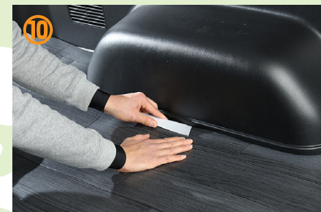
⑩サイドトリム、ステップトリムのすき間に差し込みにくい時はヘラなどで作業するとスムーズに出来ます。
