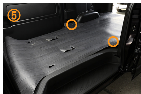
⑤～⑥パワースライドドア付車は、○部分にシートベルトアンカーボルトがありますので、まず裏面の野書きの線に沿ってカッターナイフなどでカットして下さい。
