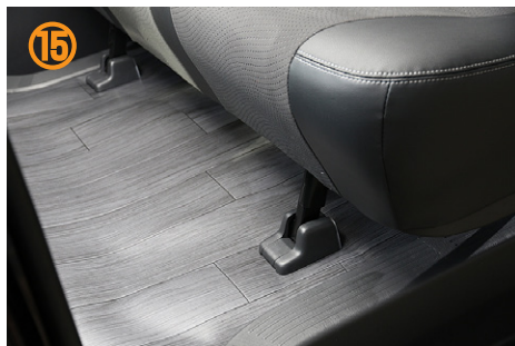
⑭ セカンドシートを元の状態に戻し、 ボルトを 14mmBOX レンチでしっかり締めて下さい。
