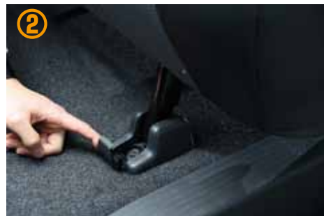
②シートを取り外していきま。セカンドシート前足のボルトカバーを開いて下さい。
