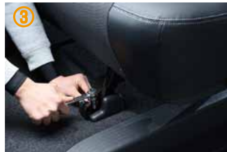
③14mmのBOXレンチでボルトを外して下さい。
