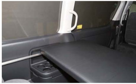
シート背面のアシストグリップを外す
