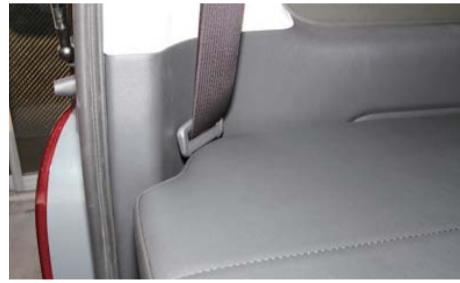
Dピラーシートベルトはベッドマット外側に収納します
